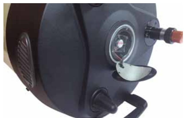
Abb. 14: Der 12VDC MagLev Lüfter mit verbessertem Lüftungsgitter ermöglicht einen guten Luftfluss im Tubus. So wird das Teleskop auf Umgebungstemperatur gebracht.
