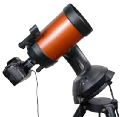
Mit einer Polhöhenwiege wird auch eine azimutale Montierung astrofototauglich. Baader Planetarium
