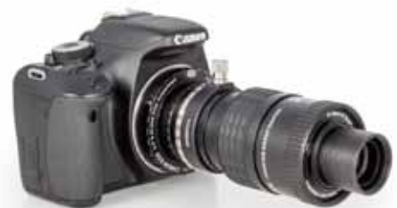
Die Kamera am Okular: Die Okularprojektion ermöglicht hohe Vergrößerung auch an großen Kameras – hier mit dem Hyperion Universal Zoom Mark IV von Baader. Baader Planetarium
