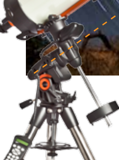
Eine parallaktische Montierung wie die Celestron AVX ist ideal für die Fotografie: Eine Achse zeigt auf den Himmelspol und gleicht die Erddrehung aus. Baader Planetarium
