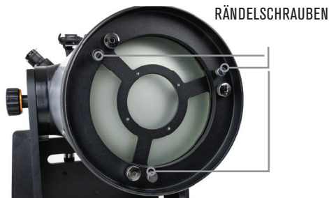
Abbildung 21: Für die 10-Zoll- und 12-Zoll-Dobsons gilt: gibt es drei federgelagerte Kollimationsschrauben, mit denen die Neigung des Hauptspiegels angepasst wird. Die anderen drei Rändelschrauben fixieren den Spiegel, sobald die Neigungsanpassung abgeschlossen ist.
