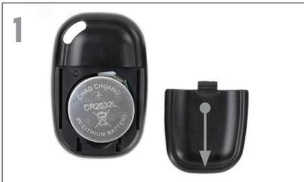
Um die Batterie einzulegen oder auszutauschen, legen Sie Ihren Daumen auf die Mitte der hinteren Abdeckung, drücken Sie nach innen und schieben Sie den Batteriefachdeckel nach unten, um ihn zu entfernen. Die CR2032-Batterie muss mit dem Pluspol (+) nach oben eingelegt werden. Setzen Sie den Batteriefachdeckel wieder ein.
