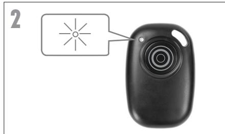
Halten Sie die Taste auf der Fernbedienung 5 Sekunden lang gedrückt. Eine blaue LED leuchtet auf und beginnt nach einigen Sekunden zu blinken. Die Fernbedienung befindet sich jetzt im Kopplungsmodus.
