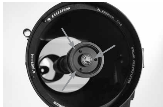
Einstellschrauben für die sekundäre Spiegelkollimation
