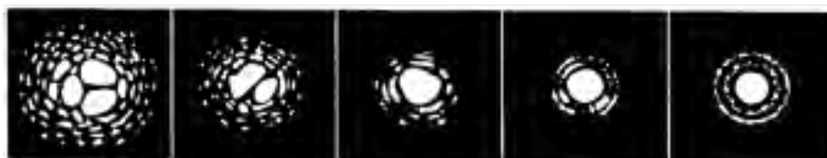
Die Sichtbedingungen wirken sich direkt auf die Bildqualität aus. Diese Abbildungen stellen eine Punktquelle (d.h. Stern) bei sehr hoher Vergrößerung unter schlechten (links) bis ausgezeichneten Sichtbedingungen (rechts) dar. Meistens erlauben die Sichtbedingungen Bilder, die irgendwo zwischen diesen Extremen liegen.
