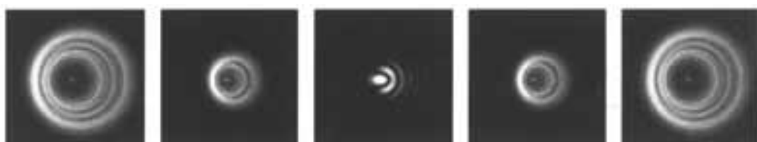
Obwohl das Sternmuster auf beiden Fokusseiten gleich aussieht, sind sie asymmetrisch. Die dunkle Behinderung ist nach links vom Diffraktionsmuster verzerrt, was eine unzureichende Kollimation anzeigt.
