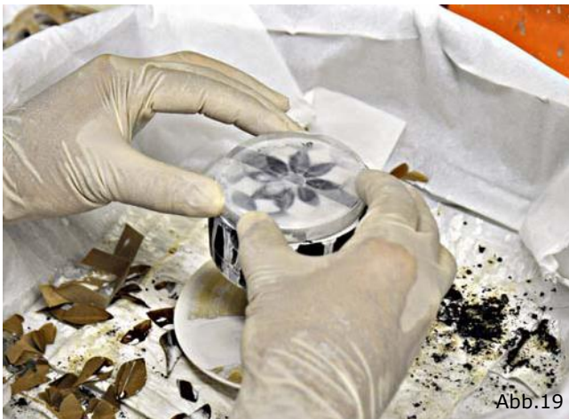
Abbildung 19 zeigt die Handretouche (Nacharbeitung) eines Fangspiegels
